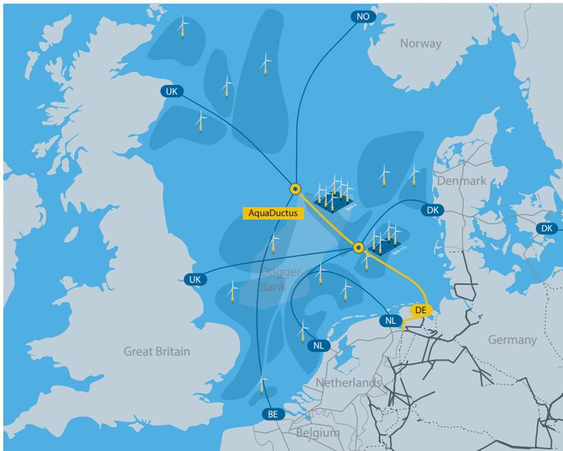
giegewinnungsfläche) mit einer Erzeugungskapazität von rund einem Gigawatt anschließen. SEN-1 liegt in der deutschen AWZ nordwestlich der Insel Helgoland. Die 200 Kilometer lange Offshore-Pipeline wird den aus der Offshore-Windkraft erzeugten grünen Wasserstoff im Raum Wilhelmshaven an das deutsche Festland und von dort via einer 100 Kilometer langen Onshore-Pipeline nach Bunde bringen und von dort zu den nachgelagerten europäischen Verbrauchern transportieren.
